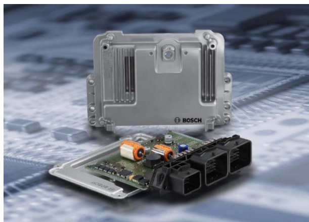
Zintegrowany sterownik dla aplikacji samochodowych (zdjęcie od Robert Bosch GmbH)
